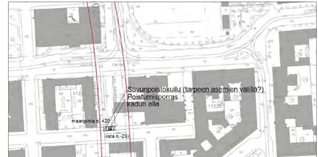
Kuva 1.39. Alppirinteen pystykuilu (vaihtoehdossa 2 ja 3).
