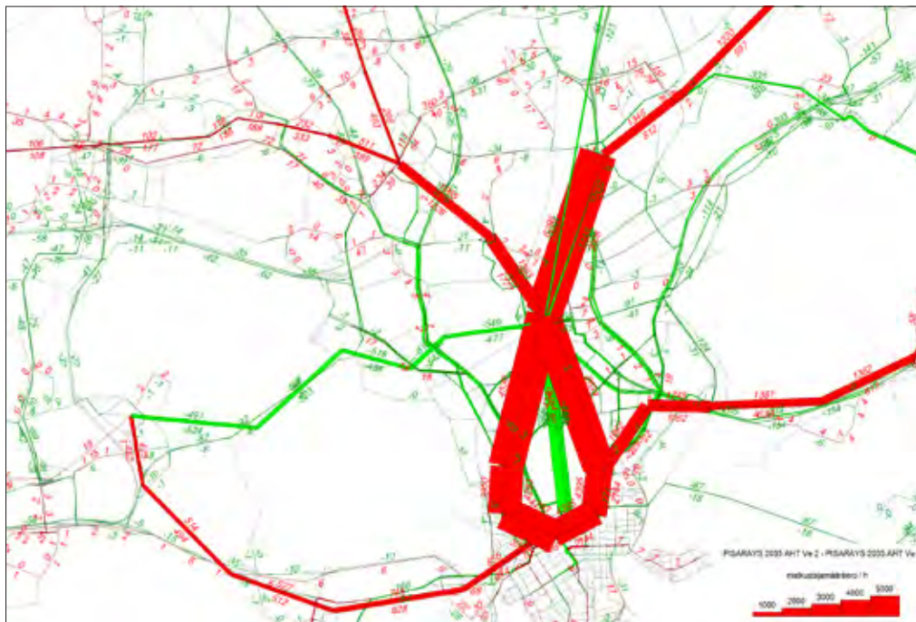
Kuva 6.9. Joukkoliikenneverkon kuormitusmuutos aamuhuipputuntina 2035 hankevaihtoehdossa 2 vertailuvaihtoehtoon 0+ nähden. Vaihtoehtoon 1 nähden Käpylän ja Pasilan välinen kuormitusmuutos johtuu erilaisesta linkkimäärästä.
